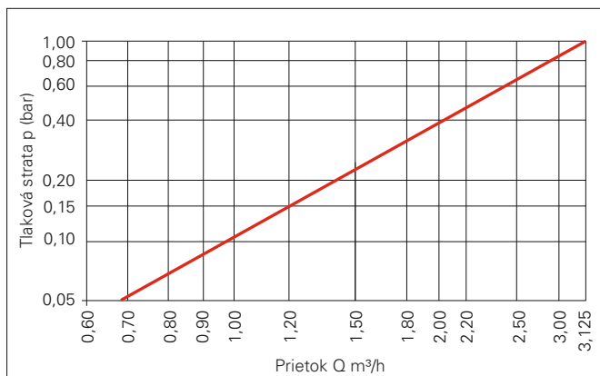
Krivka tlakovej straty kapsulových vodomerov (podomietkových aj nadomietkových)
